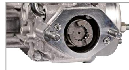
La flangia di montaggio degli attrezzi è in acciaio, l'albero PTO ha un **diámetro 25 mm e innesto a 3 denti**. L'attacco rapido è opzionale e consente di intercambiare gli attrezzi senza utilizzare chiavi.
