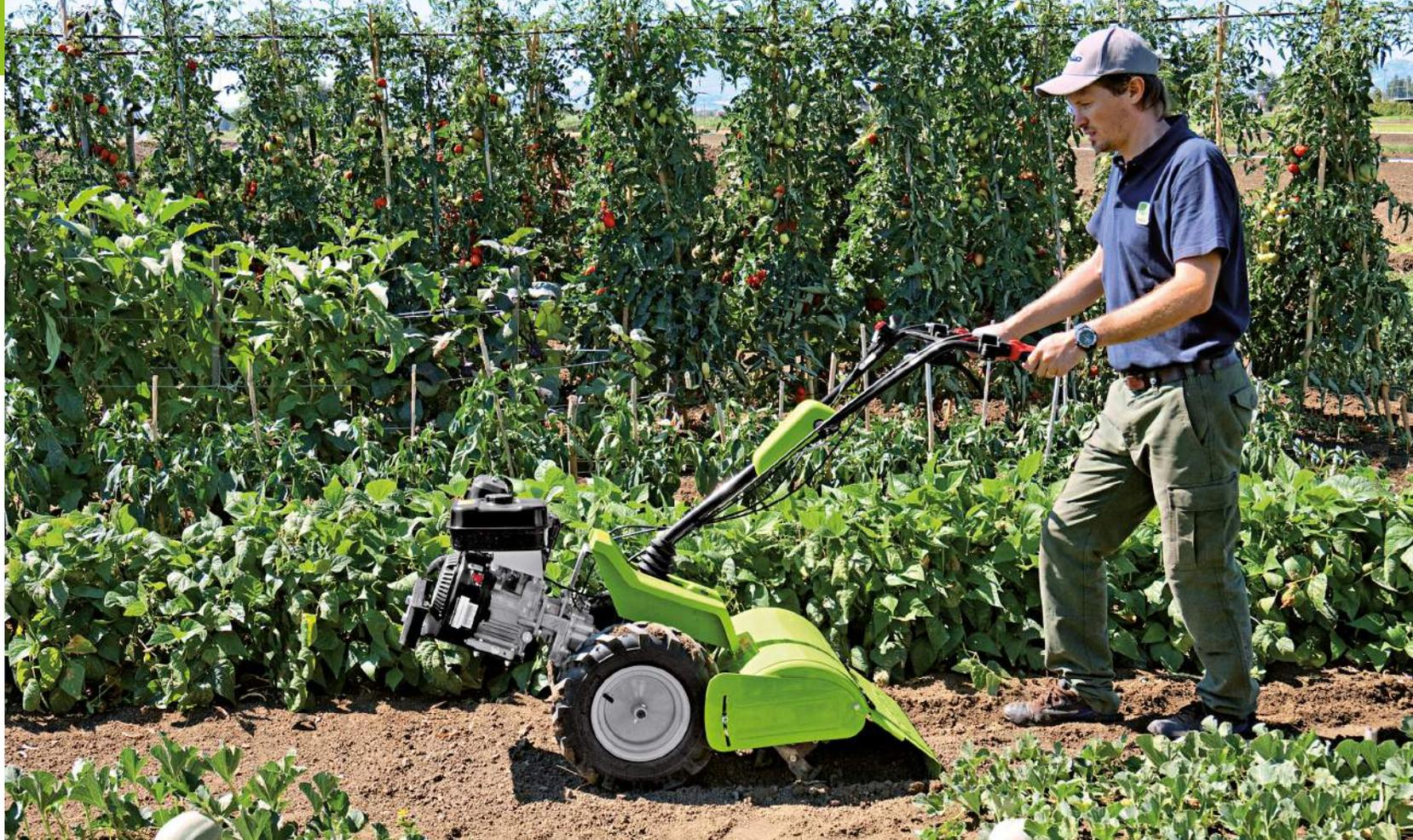
Il comando dell'avanzamento è ad **innesto attivo**: quando la leva viene rilasciata le ruote si fermano immediatamente ed il motore rimane in moto. Avanzamento e PTO hanno comandi indipendenti. Un **dispositivo di sicurezza** impedisce l'azionamento della fresa in retromarcia.
