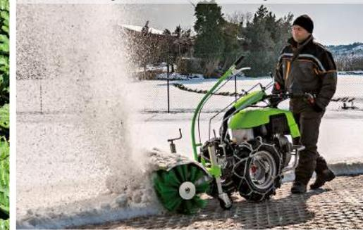
La **frizione è a comando attivo**: ..... quando la leva viene rilasciata le ruote e l'attrezzo si fermano immediatamente ed il motore rimane in moto. Avanzamento e PTO hanno comandi indipendenti. Un dispositivo di sicurezza impedisce l'azionamento della fresa in retromarcia (con accessorio posteriore).
