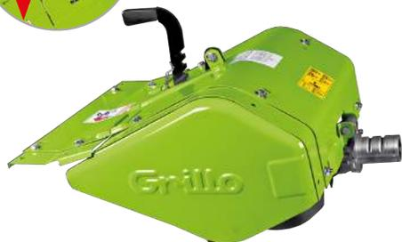
La **profondità di fresatura** si regola agendo sulla comoda leva esterna al cofano fresa. Per una migliore resa è possibile agire anche sul **coltello al centro delle zappe**; è a tre posizioni, per terreni duri, medi e morbidi/sabbiosi.
