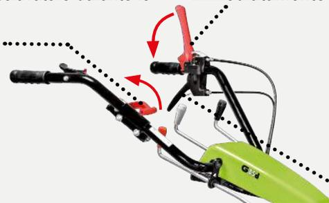
I **freni** opzionali sono utili in condizioni di pendenza e agevolano la sterzata, in modo particolare con gli attrezzi più pesanti come i trincia; azionati da due leve sul manubrio sono dotati di blocco per essere utilizzati anche come freno di stazionamento.
