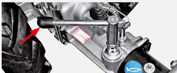
La **frizione è a comando attivo**: quando la leva viene rilasciata le ruote e l'attrezzo si fermano immediatamente ed il motore rimane in moto. Avanzamento e PTO hanno comandi indipendenti. Un **dispositivo di sicurezza** impedisce l'azionamento della fresa in retromarcia (con accessorio posteriore).
