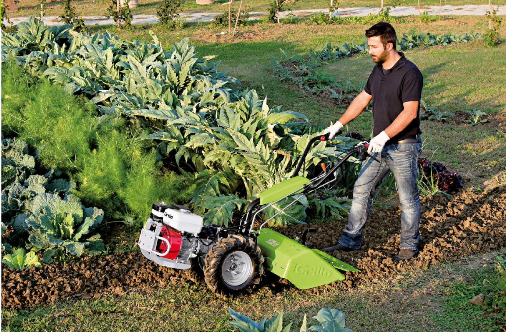
La **frizione** è a **comando attivo**: quando la leva viene rilasciata le ruote e l'attrezzo si fermano immediatamente ed il motore rimane in moto. Avanzamento e PTO hanno comandi indipendenti. Un **dispositivo di sicurezza** impedisce l'azionamento della fresa in retromarcia (con accessorio posteriore).
