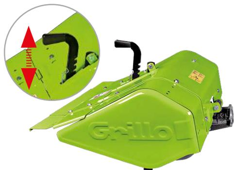
La **profondità di fresatura** si regola agendo sulla comoda leva esterna al cofano fresa. Per una migliore resa è possibile agire anche sul **coltello al centro delle zappe**; è a tre posizioni, per terreni duri, medi e morbidi/sabbiosi.
