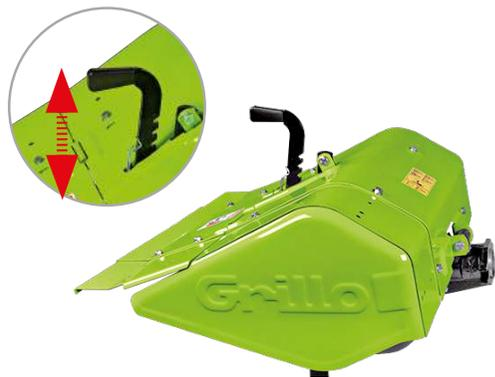
La **profondità di fresatura** si regola agendo sulla comoda leva esterna al cofano fresa. Per una migliore resa è possibile agire anche sul **coltello al centro delle zappe**; è a tre posizioni, per terreni duri, medi e morbidi/sabbiosi.
