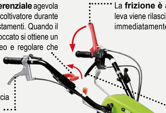
La **frizione** è a comando attivo: quando la leva viene rilasciata le ruote e l'attrezzo si fermano immediatamente ed il motore rimane in moto.
