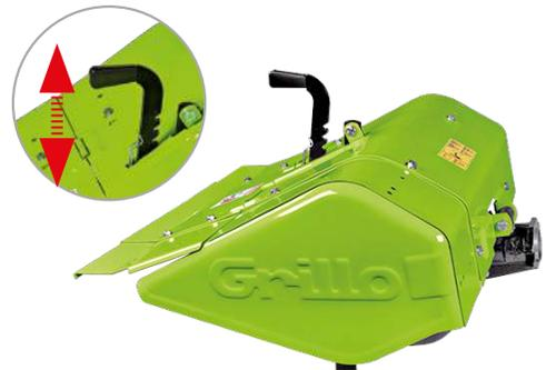
La **profondità di fresatura** si regola agendo sulla comoda leva esterna al cofano fresa. Per una migliore resa è possibile agire anche sul **coltello al centro delle zappe**; è a tre posizioni, per terreni duri, medi e morbidi/sabbiosi.
