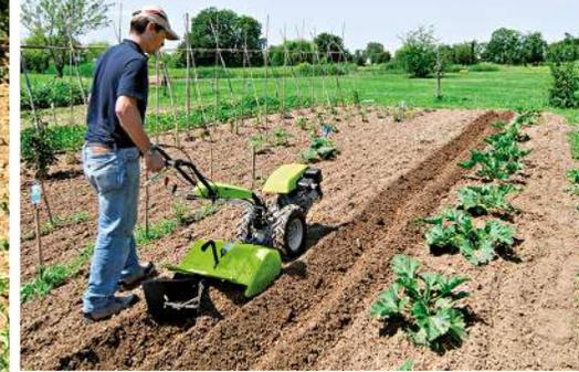
L'**attacco rapido** è presente di serie sul G 55 e consente di intercambiare gli attrezzi velocemente. Il bloccaggio si effettua ruotando una pratica leva, senza utilizzare chiavi.
