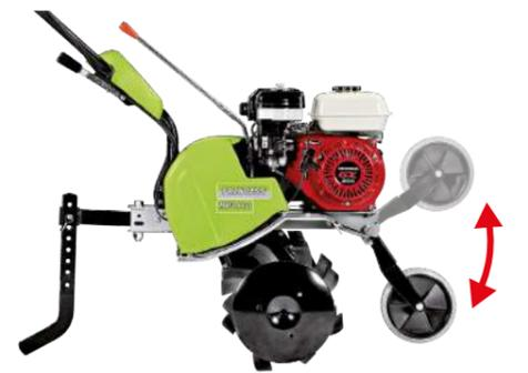
**La fresa standard** è larga 97 cm e consente una profondità di fresatura fino a 33 cm. È costituita da 6 stelle di zappe con dischi laterali. Le zappe realizzate in acciaio temprato sono fissate tramite bulloni. L'albero zappe è **esagonale** da 27 mm.
