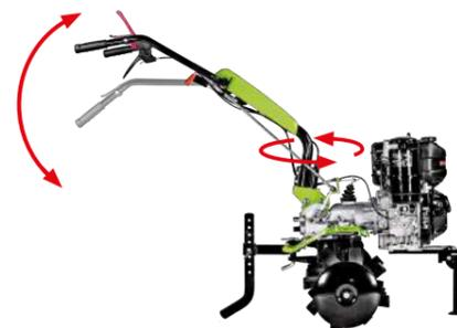
Due sono le **prese di forza**: quella superiore ha rotazione antioraria, è collegata direttamente al motore ed è ad albero calettato 11 UNI 221, quella inferiore ha rotazione oraria sincronizzata con il cambio ed è ad albero calettato 13 UNI 221.
