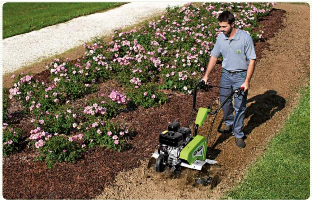
**I dischi laterali** mantengono in guida la macchina e determinano con precisione la zona fresata.
